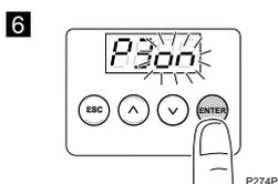
☞ Avant l'enregistrement, effectuez un mouvement d'ouverture et de fermeture à vitesse normale et lente, pour détecter les intensités correspondantes (paramètre R6XY).
